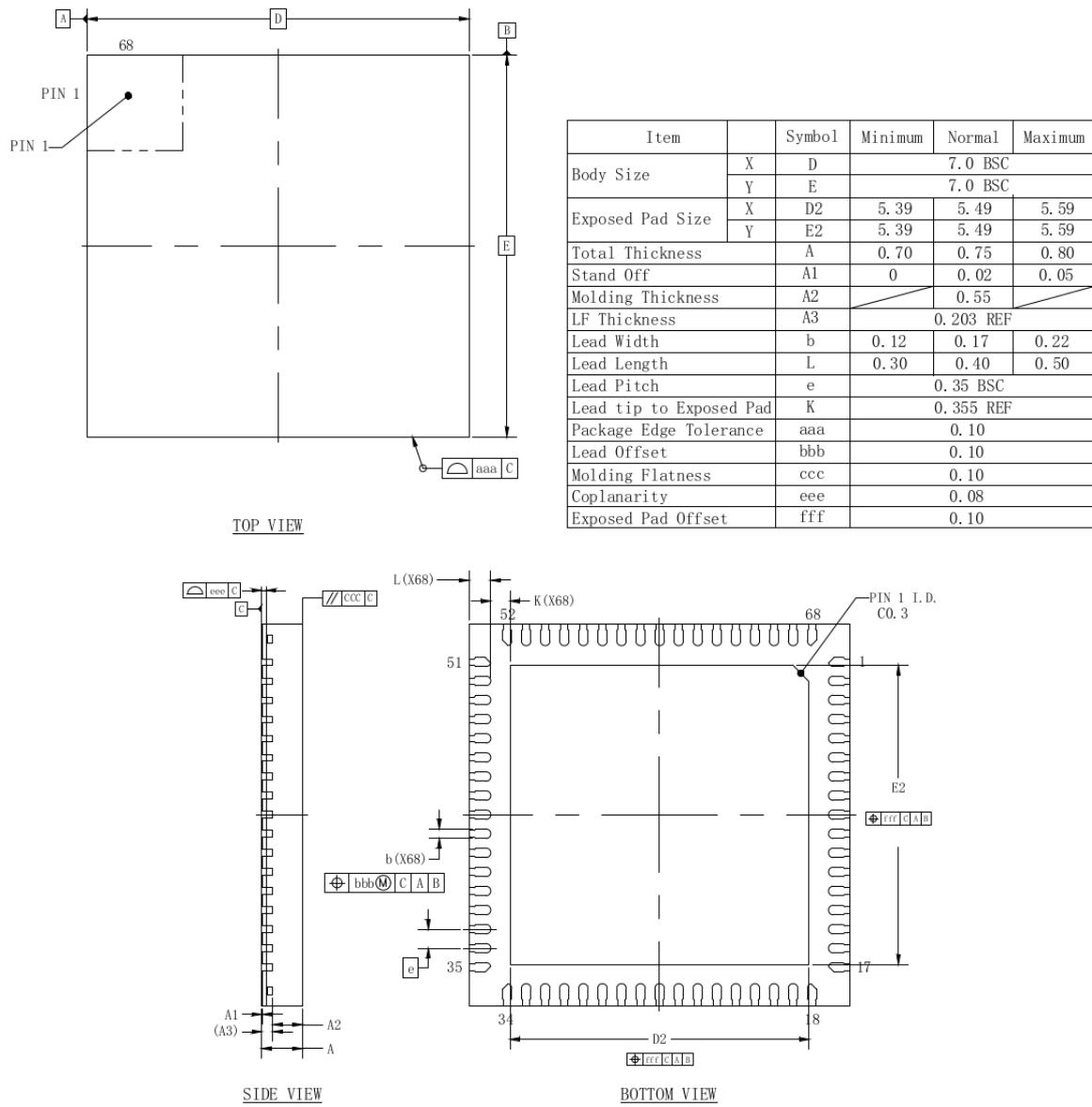
图 7.1: QFN68 封装机械尺寸图
